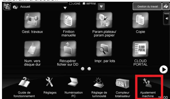
※Lorsque l'appareil est en cours d'utilisation, l'écran [Réglage de l'appareil] ne peut pas être atteint. Si vous appuyez sur [Réglage de l'appareil], les messages suivants s'affichent en émettant un bip : L'ajustement de la machine n'est pas disponible en raison du travail actuellement réservé/exécuté.
