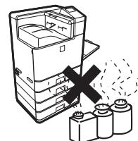
L'installation de la machine à côté d'une photocopieuse diazo peut provoquer des impressions sales.
